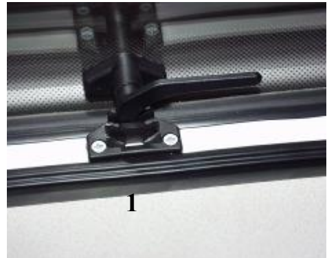
Bild 6-2 Verriegelung in Dauerbelüftung (Variante 1)
